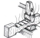
Utilisation d'un dégorgoir sur les deux faces pour abaisser la partie du milieu.
